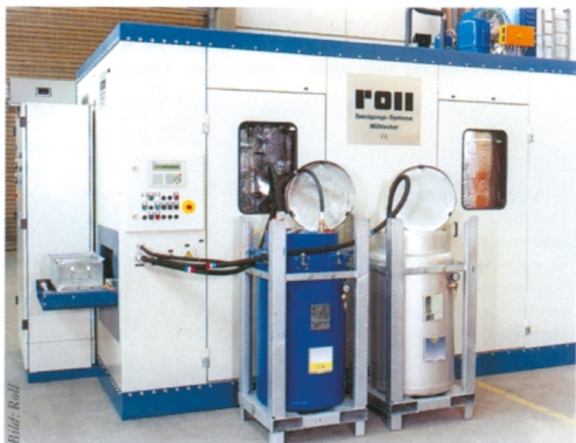
Der rechte Container versorgt die Reinigungsanlage mit frischem CKW, daneben der 200-Liter-Altware-Container
